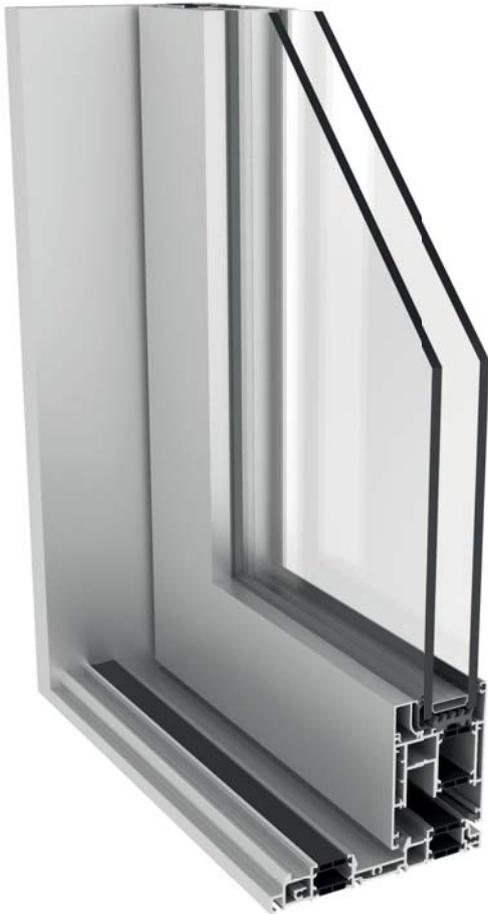
Sistema a taglio termico per serramenti alzanti per grandi vetrate. Permette di raggiungere portate fino a 440kg per anta; i carrelli scorrono su profili di acciaio inox AISI 316 grazie ai quali il meccanismo scorre facilmente anche con pesi elevati ed è resistente alla corrosione salina.
