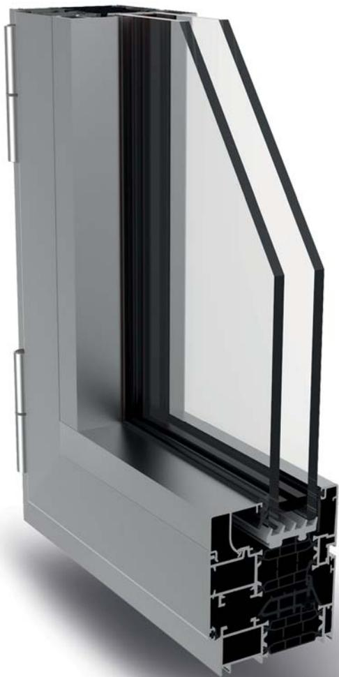
Il Planet 72 UP è la serie più performante della gamma Planet. Con una sezione di soli 72 mm, la serie si caratterizza per elevatissimi standard termici ed acustici raggiunti grazie al nuovo taglio termico da 38 mm in poliammide a bassa densità ed inserti in PUR.
