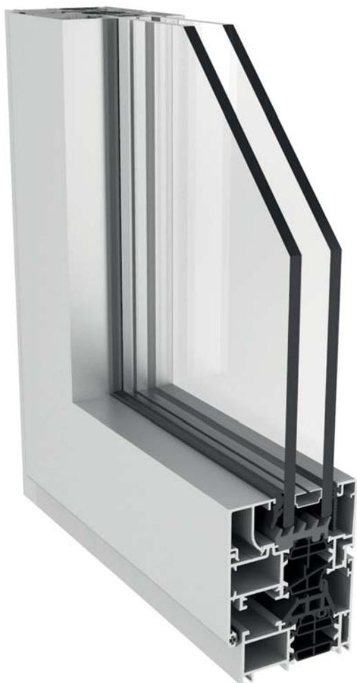
Nuovo sistema a taglio termico, con sezione telaio di soli 62mm, che garantisce ottime prestazioni termo-acustiche e di tenuta agli agenti atmosferici. Le nuove barrette tubolari, realizzate in poliammide a bassa densità, migliorano le prestazioni termiche del sistema, utilizzabile per ECOBONUS e SUPERBONUS. Inoltre grazie all'utilizzo di alluminio rigenerato, la serie rispetta i CAM (Criteri Ambientali Minimi).
