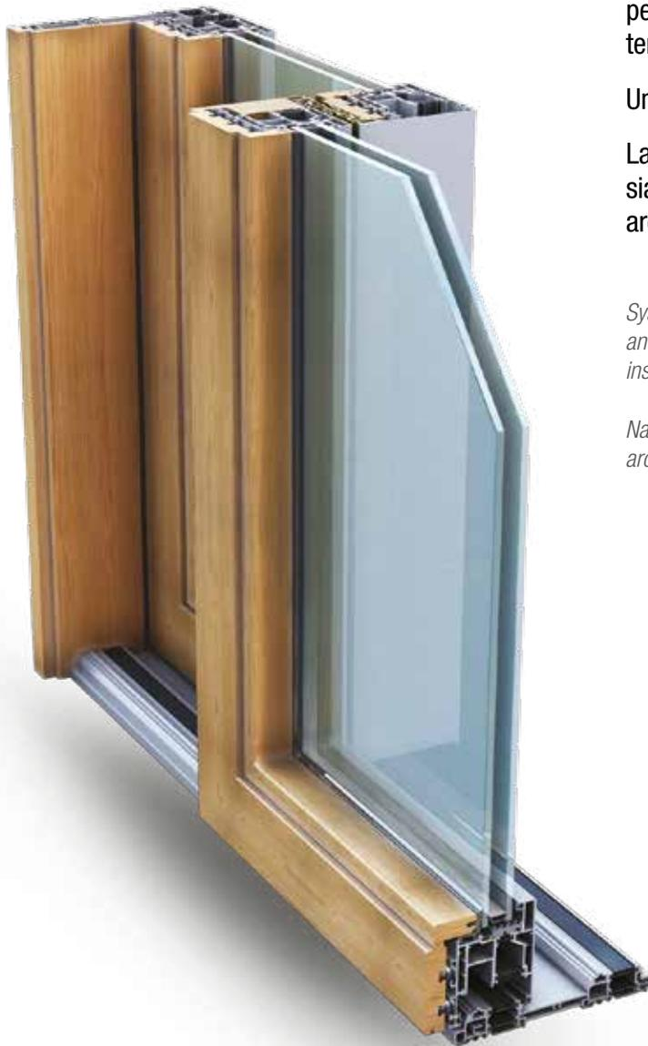
Sistema per serramenti alzanti a scorrere a taglio termico per grandi dimensioni e peso. Elevate prestazioni, classi di tenuta e di isolamento acustico.
