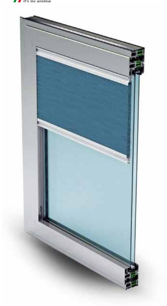
Easysun è la tenda da sole oscurante completamente integrata alla vostra finestra. Il nuovo fermavetro cavo PL1325, montato sui sistemi Planet 50 e 62 TT, Planet 72 HT e Top Slide 160, funziona da binario per il montaggio a incastro della tenda. Easysun è semplice da installare e grazie ad una vasta gamma di colori e soluzioni, diventa un elemento d'arredo, di gestione della luce solare e di privacy.
